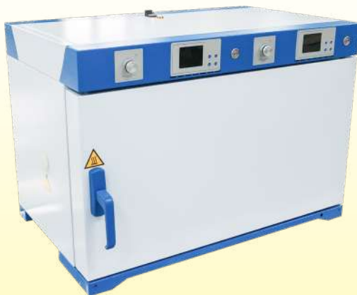
用于在B高达200°C和在M高达150°C的测试装置示例
